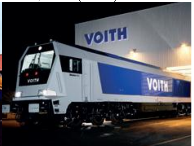
Locomotiva Diesel Hidraulica VOITH MAXIMA 40cc (cea mai puternica locomotiva hidraulica monomotor) 16VDZC, 3600KW(4900CP)
